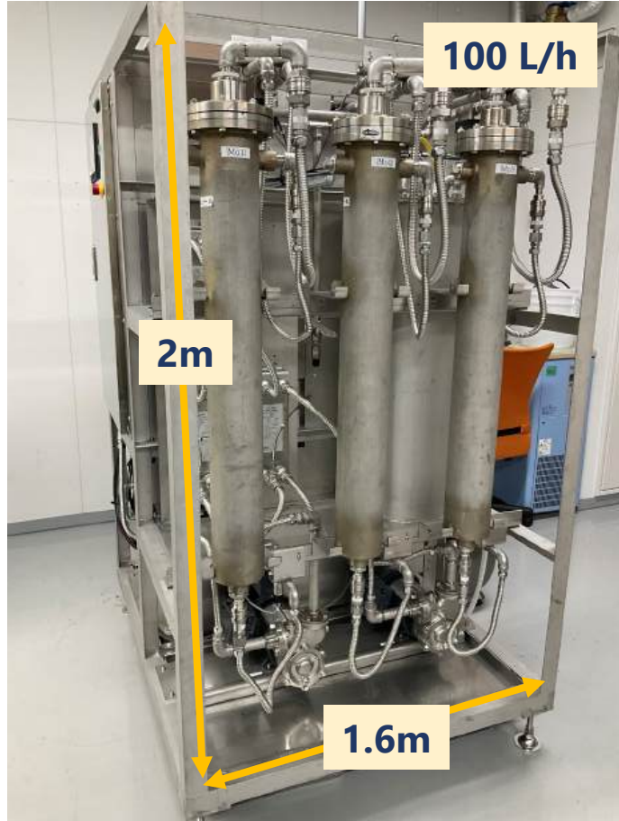
浸透気化分離装置
