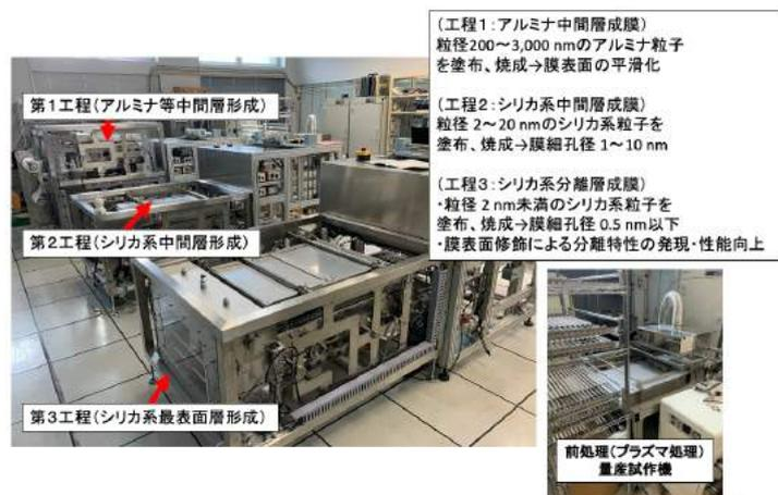
図 4. シリカ系分離膜の生産設備構築状況。
