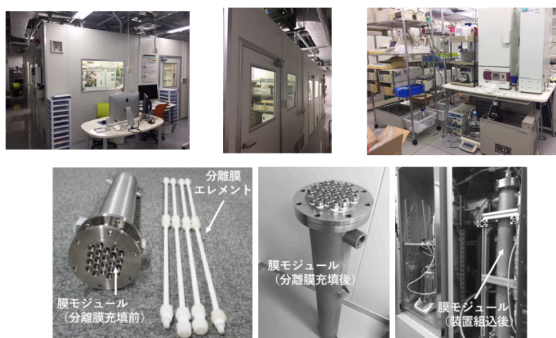
図 7. 京都市成長産業創造センター内の膜検査設備（例）.
